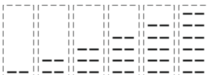
Рисунок 12 - Графическое отображение процесса заряда АКБ на ЖК-дисплее.
